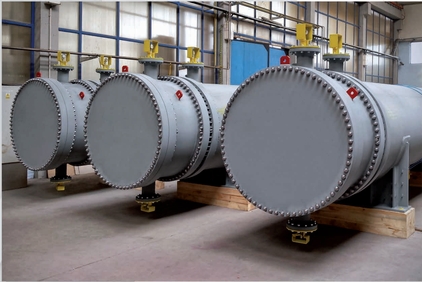
Wymienniki ciepła typ AES – wykonanie wg ASME z U-stamp
