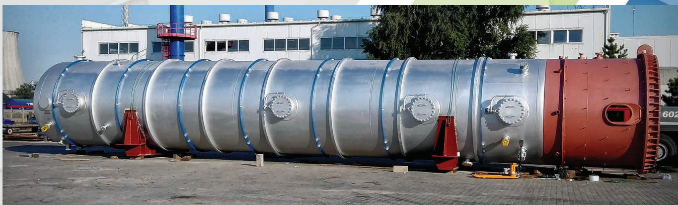
Reaktor na instalację masy bitumicznej
