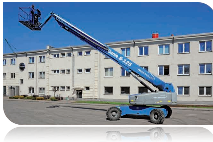
PODNOŚNIK KOSZOWY GENIE S-125 udźwig 227kg wysokość robocza 40m
